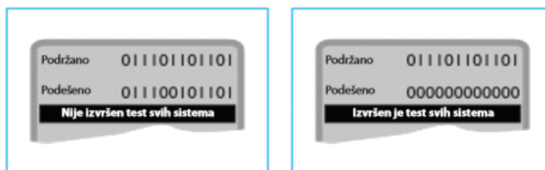
Slika 5. Kod spremnosti i prikaz na monitoru pod uslovom da nije i da jeste izvršen test
